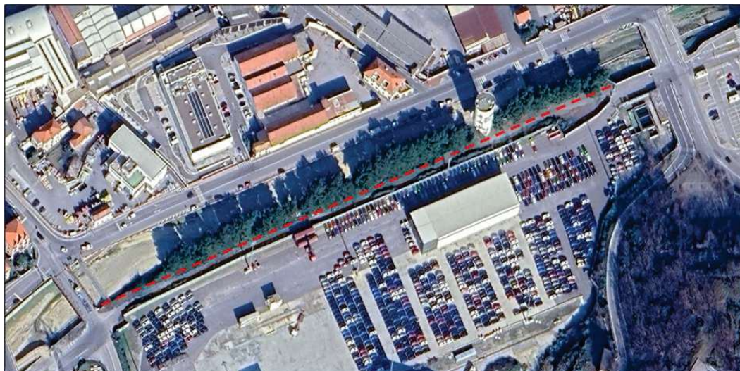
Figura 8 - Indicazione dell'allargamento dell'alveo del Torrente Segno nel tratto di intervento
