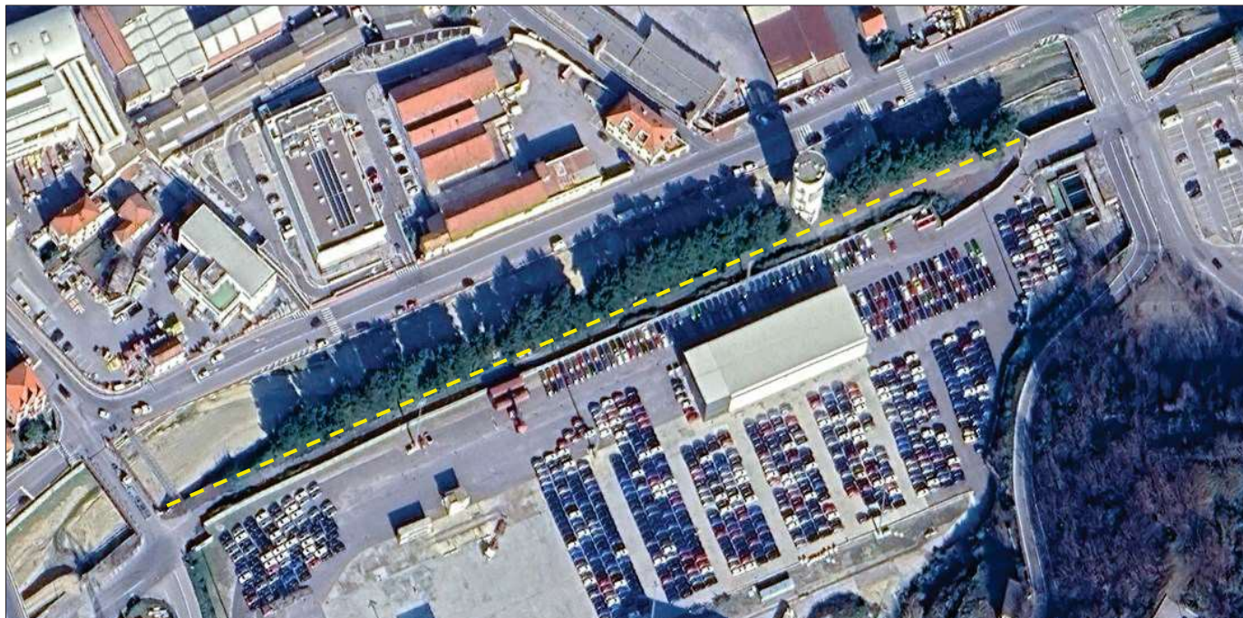
Figura 6 - Indicazione dell'allargamento dell'alveo del Torrente Segno nel tratto di intervento
