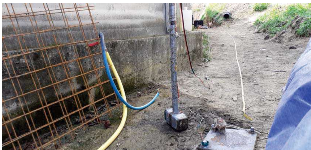
Indagine MASW: prima energizzazione in offset ( D = 10 m da geofono G1)
