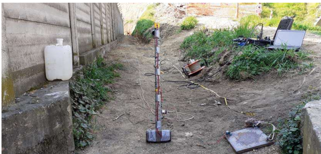
Stendimento sismico tomografico SS1, estremo iniziale (piastra in offset lato geofono G1)
