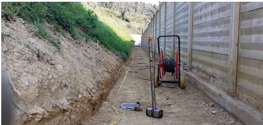
Stendimento sismico tomografico SS1, estremo finale (piastra in offset lato geofono G17)
