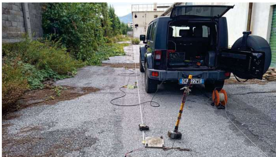
Array MASW_2: ultima energizzazione in offset ( D = 3.0 m da geofono G1, coincidente con Shot1 di SS2)
