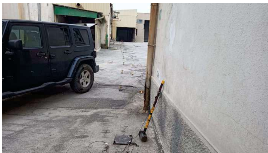
Array MASW_4: ultima energizzazione in offset ( D = 3.0 m da geofono G1)
