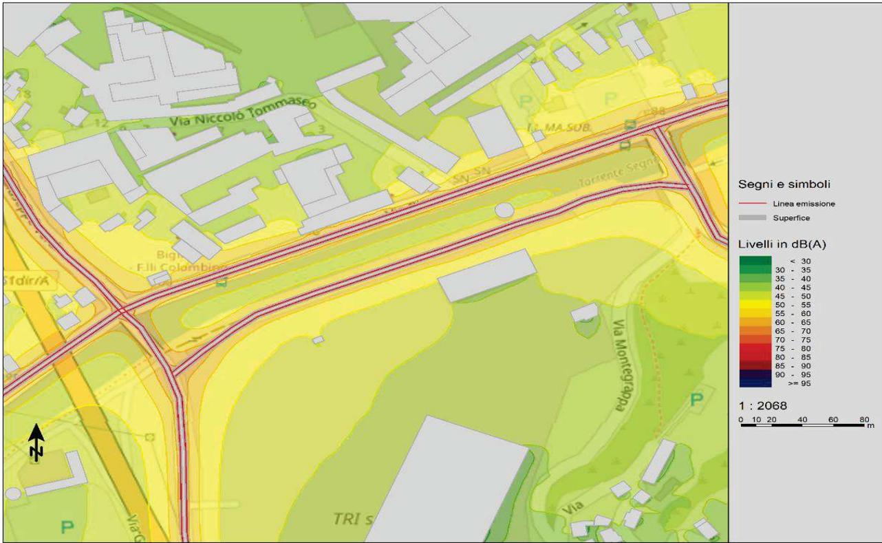
Figura 17 – mappa del rumore medio dello Stato di Progetto nel periodo diurno
