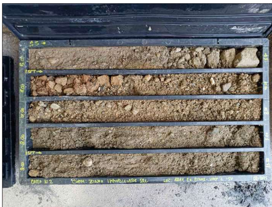
Sondaggio S5 - Cassetta 2 Profondità 5.00 - 10.0 m
