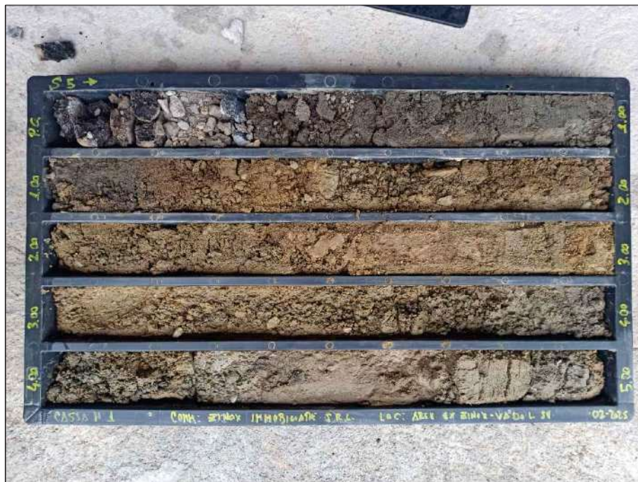
Sondaggio S5 - Cassetta 1 Profondità 0.00 - 5.00 m
