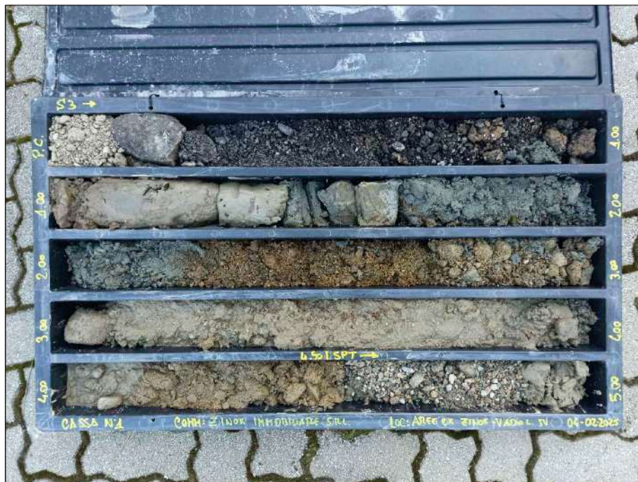
Sondaggio S3 - Cassetta 1 Profondità 0.00 - 5.00 m
