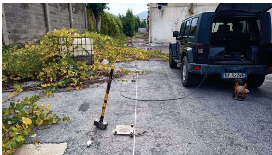
Array sismico SS2: Shot 1, 3.0 m in offset dal geofono G1
