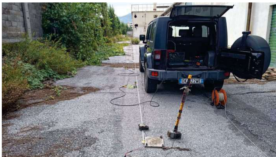
Array sismico SS1: Shot 1, 3.0 m in offset dal geofono G1
