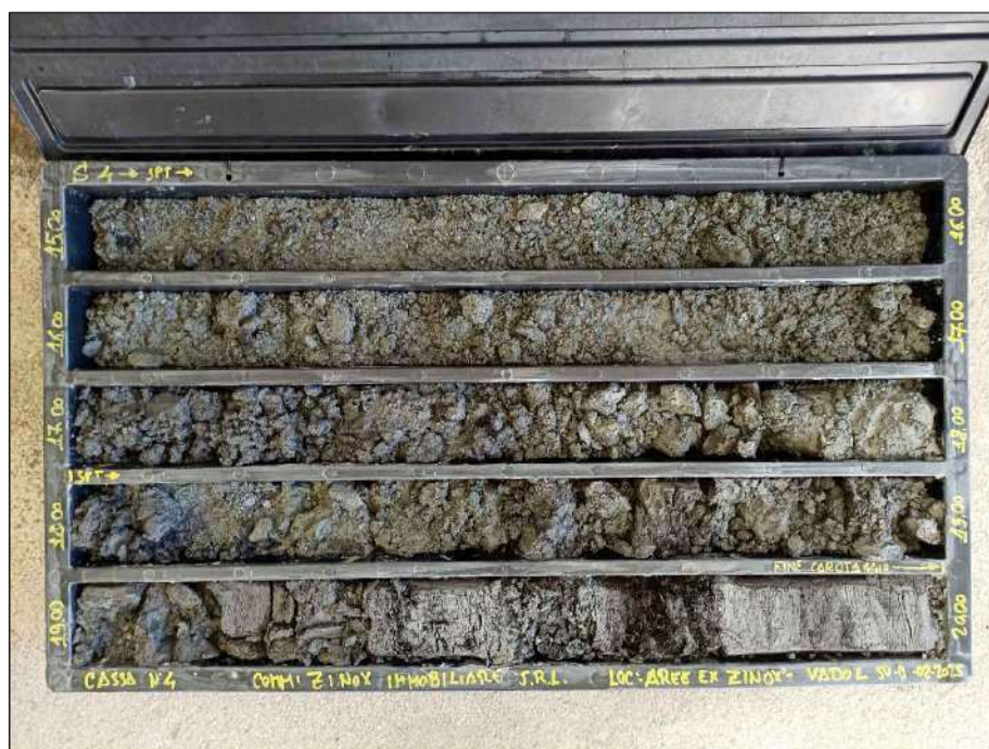
Sondaggio S4 - Cassetta 4 Profondità 15.00 - 20.0 m
