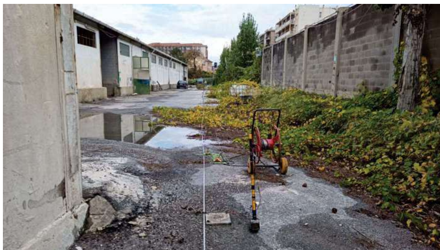
Array sismico SS1: Shot 9, 3.0 m in offset dal geofono G24
