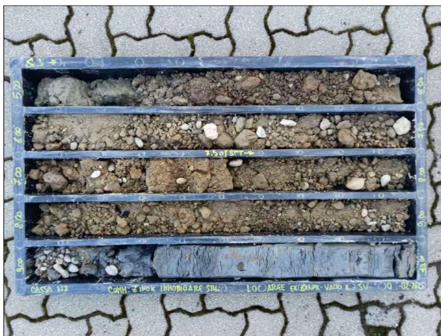
Sondaggio S3 - Cassetta 2 Profondità 5.00 - 10.0 m
