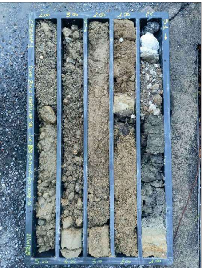
Sondaggio S1 - Cassetta 1 Profondità 0.00 - 5.00 m
