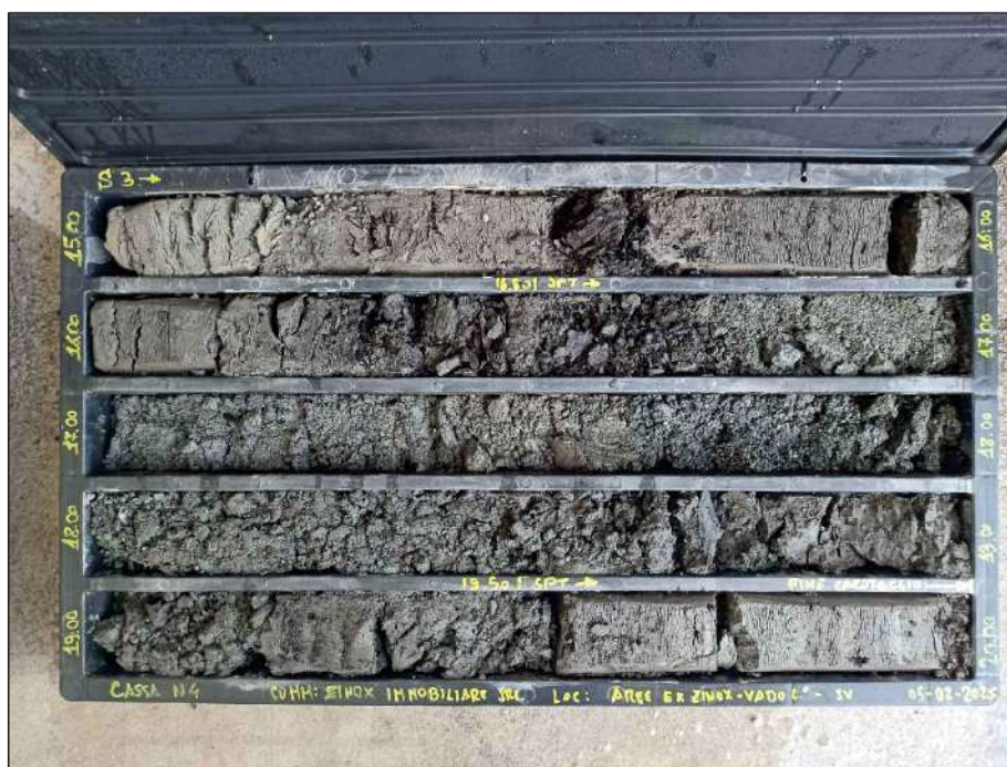
Sondaggio S3 - Cassetta 4 Profondità 15.00 - 20.0 m
