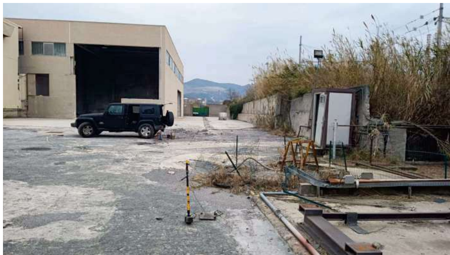
Array MASW_3: prima energizzazione in offset ( D = 15.0 m da geofono G1)
