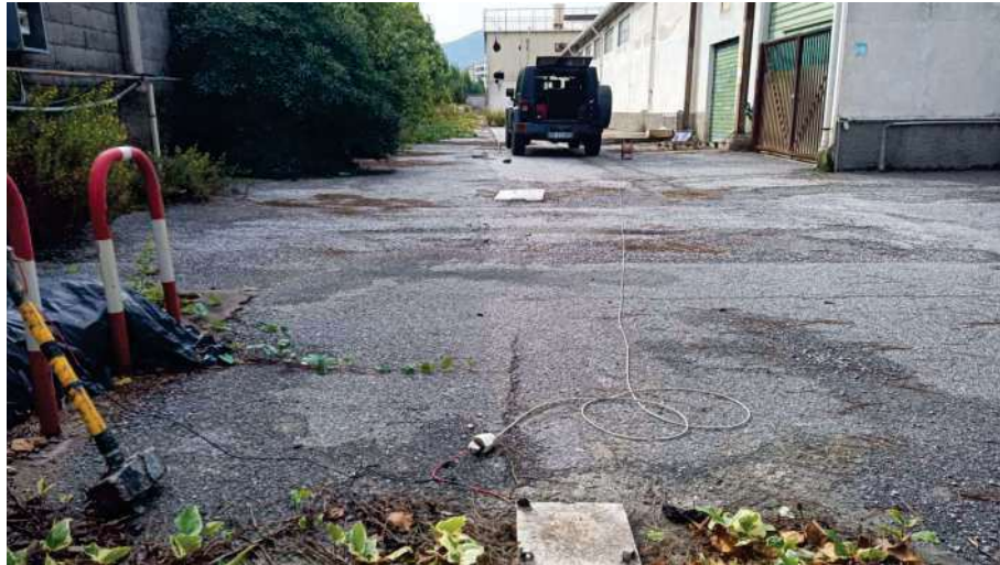
Array MASW_1: prima energizzazione in offset ( D = 15.0 m da geofono G1)
