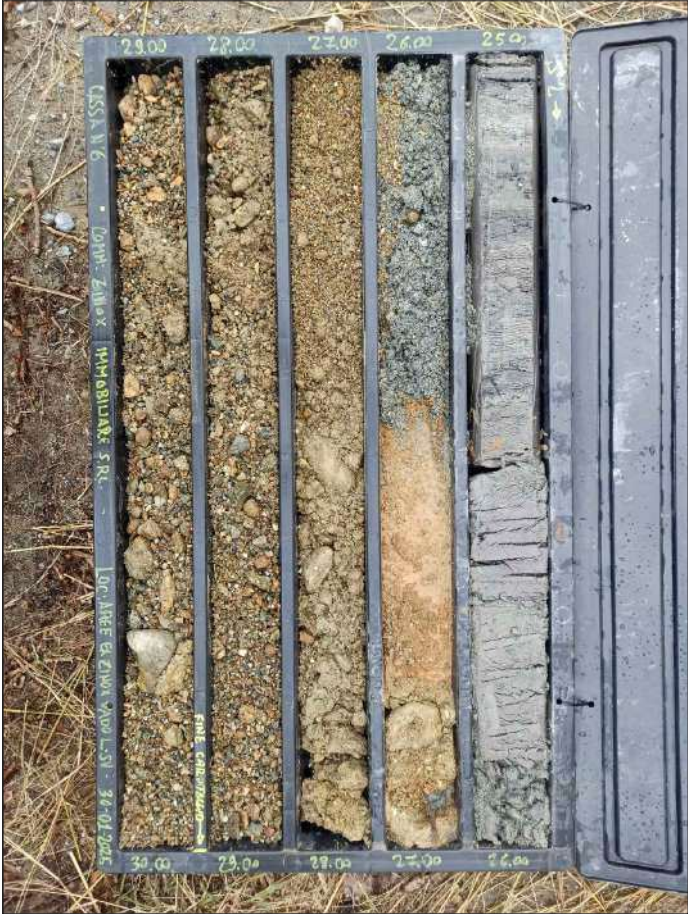
Sondaggio S2 - Cassetta 5 Profondità 20.00 - 25.00 m
