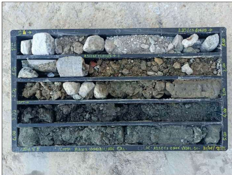
Sondaggio S4 - Cassetta 1 Profondità 0.00 - 5.00 m
