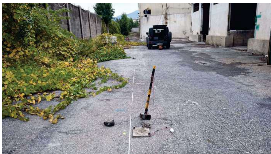
Array MASW_2: prima energizzazione in offset ( D = 15.0 m da geofono G1)
