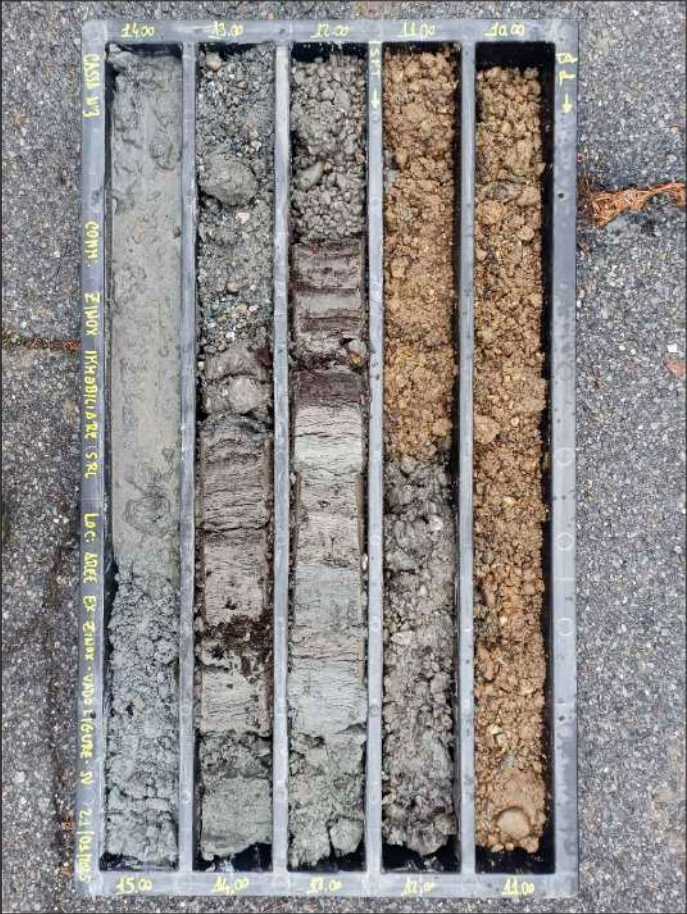
Sondaggio S1 - Cassetta 3 Profondità 10.00 - 15.00 m
