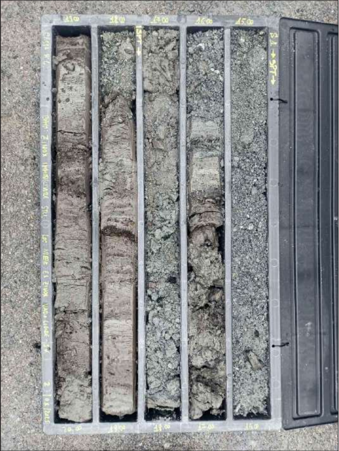
Sondaggio S1 - Cassetta 3 Profondità 10.00 - 15.00 m
