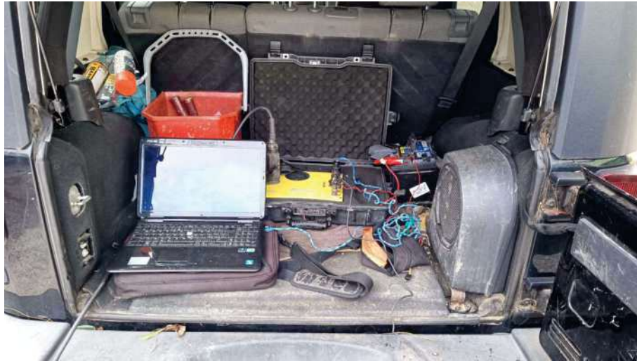
Sistema di acquisizione Seismic Source Daq Link III
