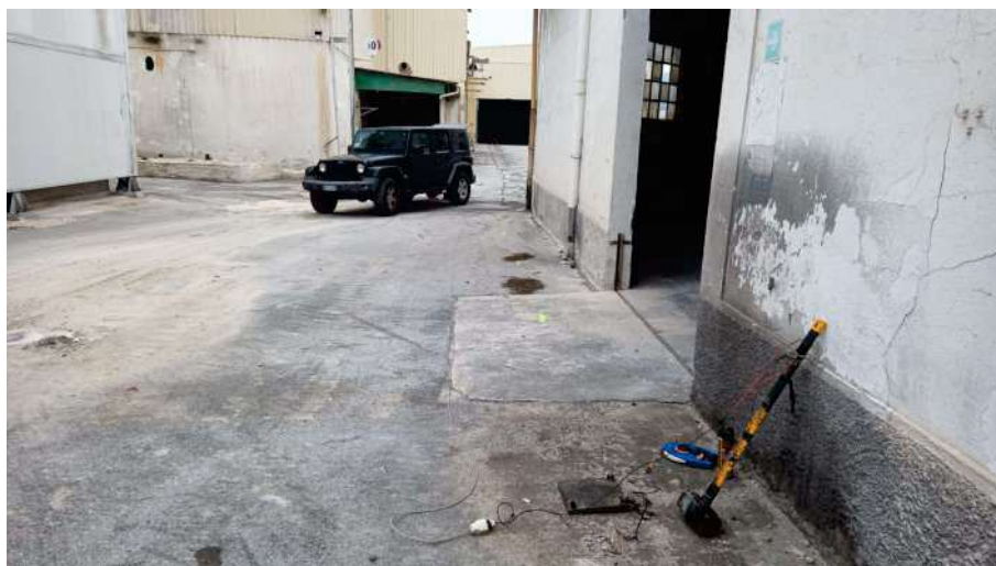
Array MASW_4: prima energizzazione in offset ( D = 15.0 m da geofono G1)
