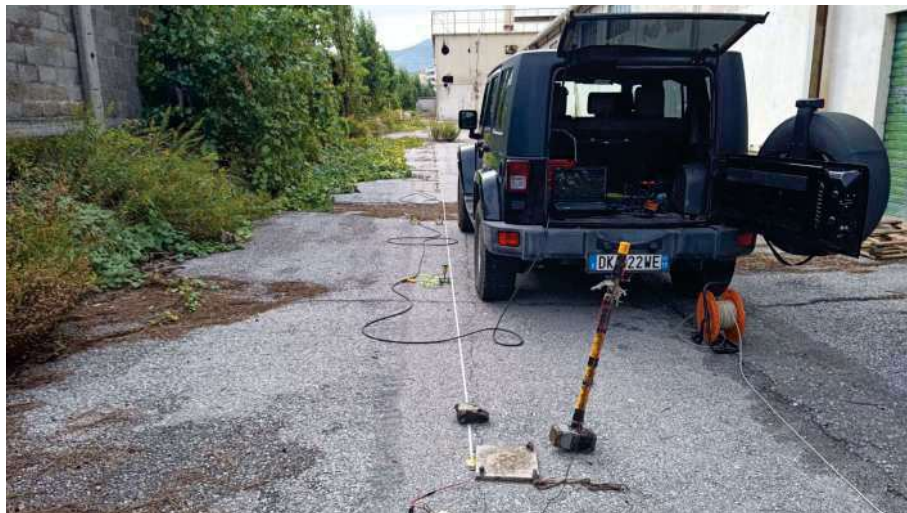
Array MASW_1: ultima energizzazione in offset ( D = 3.0 m da geofono G1, coincidente con Shot1 di SS1)
