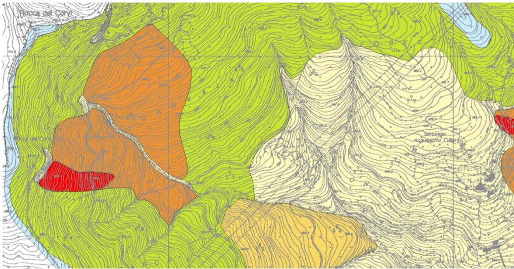
Figura 2: Area a suscettività al dissesto molto alta in area a frana attiva Pg4 a monte della vetta della Rocca dei Corvi Superiore nel Piano di Bacino del Torrente Segno
